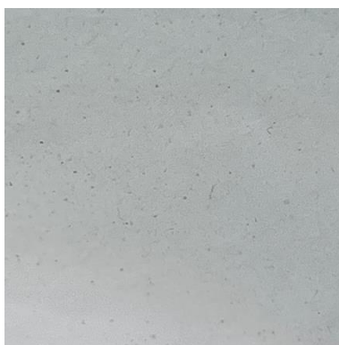
รูปที่ 1 รูปถ่ายลักษณะทางกายภาพของเส้นใยพอลิไวนิลแอลกอฮอล์ 10 % w/w และเจลาตินความเข้มข้น 2.5 % w/w อัตราส่วน 3.5:1.5 (PVA:Gelatin)
