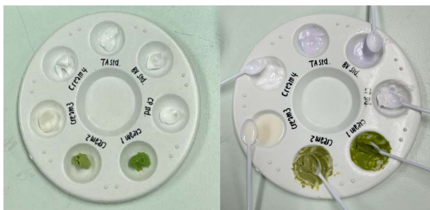
รูปที่ 17 แสดงการตรวจสอบสารสเตียรอยด์เบื้องต้นโดยใช้ชุดทดสอบสเตียรอยด์ก่อนหยดน้ำยาทดสอบ (ซ้าย) และ หลังหยดน้ำยาทดสอบ 15 นาที (ขวา)
