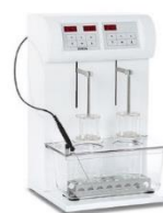
รูปที่ 19 การทดสอบการแตกตัวด้วยเครื่องวัดการแตกตัวของยา
