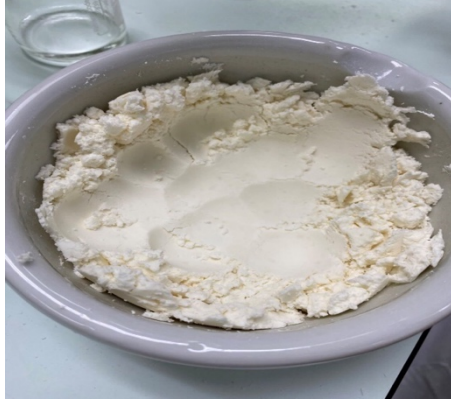
รูปที่ 3 แสดงการนำ damp mass ที่ได้มาผ่านแรงให้ได้เป็นแกรนูลเปียก (รูปตัวหนอน)
