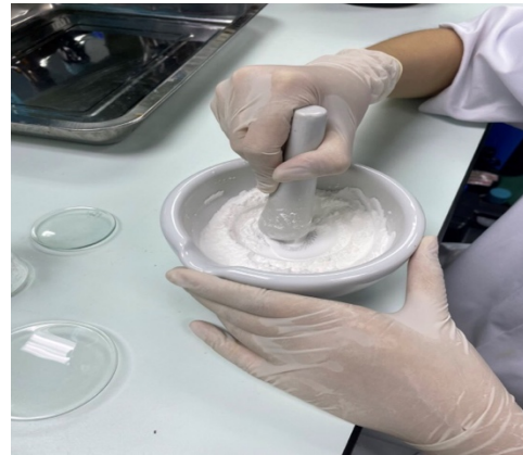
รูปที่ 1 แสดงการบดผสมสารช่วยในโกร่ง (geometric dilution)
