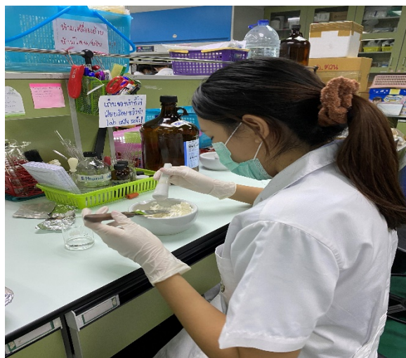
รูปที่ 2 แสดงการเติม Isopropyl Alcohol ลงไปผสมจนได้ damp mass
