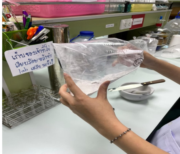
รูปที่ 5 แสดงการนำแกรนูลแห้งที่ได้มาชั่งและเติม Talcum, Aerosil และ Magnesium stearate
