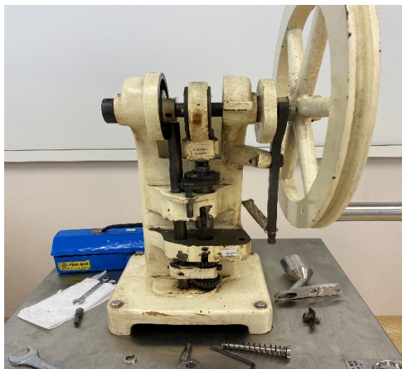
รูปที่ 6 แสดงการตอกเม็ดด้วยเครื่อง single punch tablet machine
