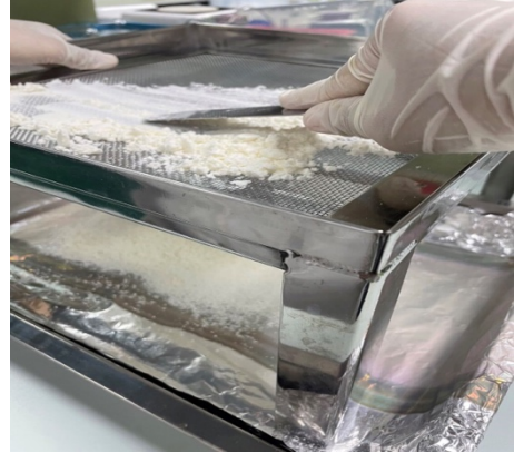
รูปที่ 3 แสดงการนำ damp mass ที่ได้มาผ่านแรงให้ได้เป็นแกรนูลเปียก (รูปตัวหนอน)
