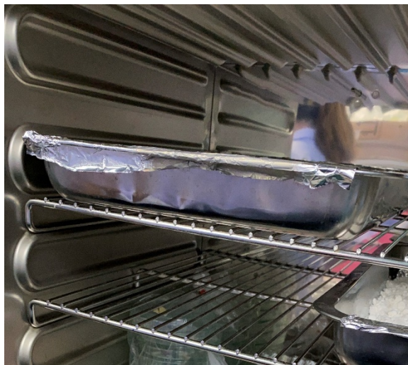
รูปที่ 4 แสดงการนำแกรนูลเปียกไปอบใน hot air oven ที่อุณหภูมิ 60 °C จนแกรนูลแห้ง
