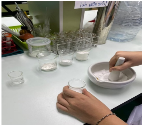
รูปที่ 1 แสดงการบดผสมสารช่วยในโกร่ง (geometric dilution)
