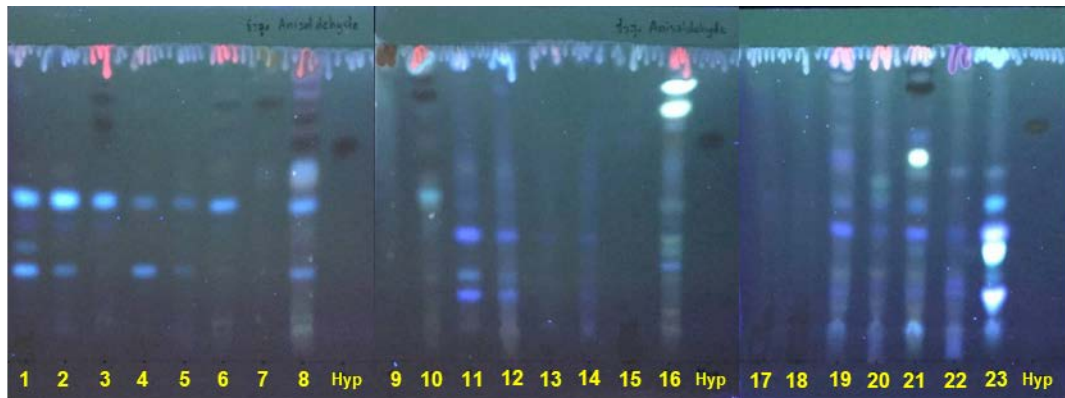
รูปที่ 22 : โครมาโตแกรมที่แอลซีของสารสกัดระบบข้าวสูง เมื่อตรวจสอบที่ความยาวคลื่น 366 nm
