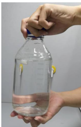
รูปที่ 4.10 การทดสอบการพลิกคว่ำด้วยขวดใสปิดฝาสนิท
