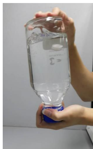
รูปที่ 4.10 การทดสอบการพลิกคว่ำด้วยขวดใสปิดฝาสนิท
