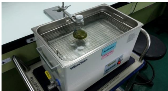
ภาพที่ 2-5 การสกัดโดยคลื่นเสียงอัลตราโซนิก (sonication)
