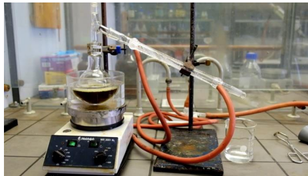
ภาพที่ 2-6 การสกัดแบบไหลย้อนกลับ (reflux extraction)
