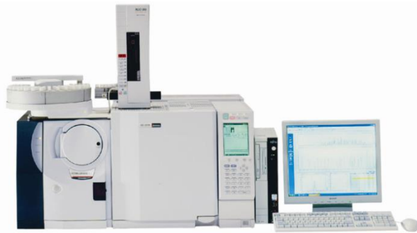
ภาพที่ 2-9 ลักษณะเครื่องแก๊สโครมาโทกราฟี-แมสสเปกโตรเมตรี (GC-MS) (34)
