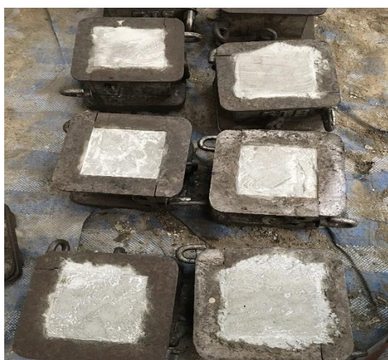
รูปที่ 3.5 คอนกรีตที่พักไว้ในแบบหล่อ 24 ชม.
