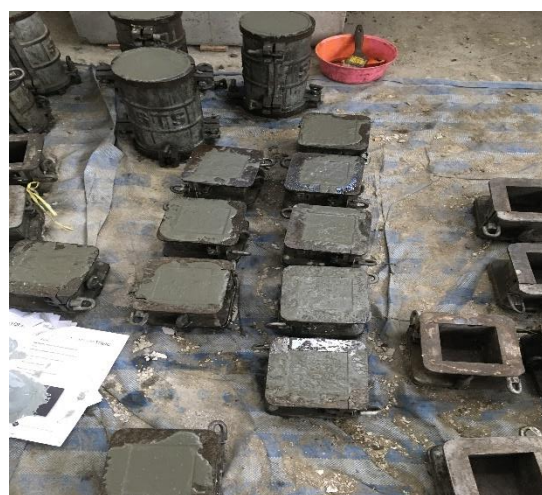
รูปที่ 3.4 เทคอนกรีตเข้าแบบหล่อ
