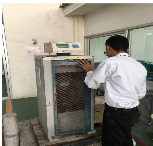
รูปที่ 3.7 ทดสอบกำลังอัดของคอนกรีต
