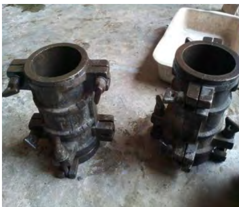
รูปที่ 3.5 แบบหล่อก้อนตัวอย่างคอนกรีต
