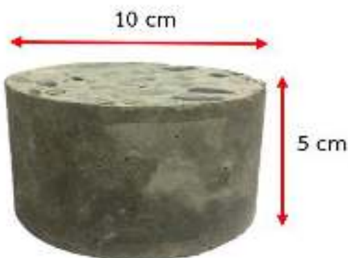
รูปที่ 3.18 ตัวอย่างคอนกรีตขนาดเส้นผ่านศูนย์กลาง 10 เซนติเมตร สูง 5 เซนติเมตร
