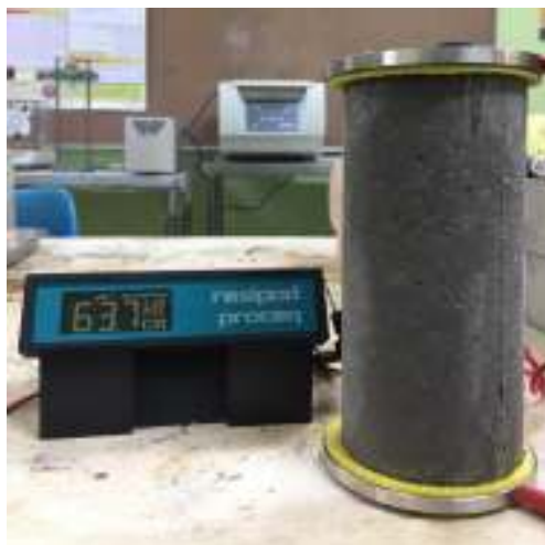
รูปที่ 3.16 การวัดค่าความต้านทานไฟฟ้าทั้งหมดของคอนกรีต
