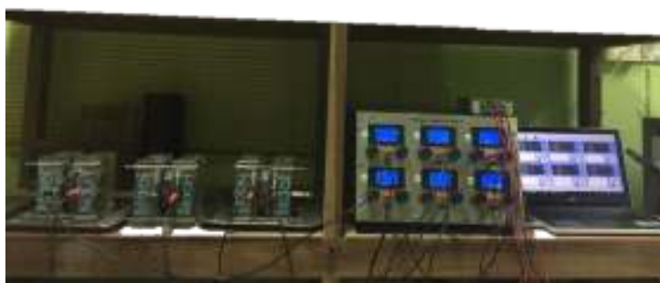
รูปที่ 3.22 วิธีการต่อสายไฟจากเครื่องควบคุมแรงดันไฟฟ้าเข้ากับเซลล์ทดสอบ
