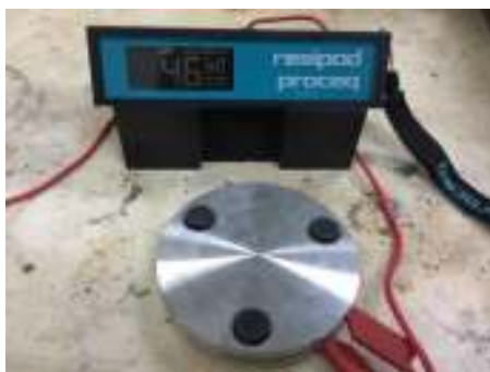
รูปที่ 3.14 การวัดค่าความต้านทานไฟฟ้าที่ฟองน้ำด้านบน
