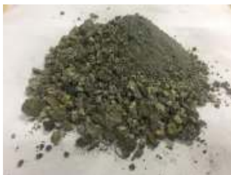
รูปที่ 3.4 เถ้าก้นเตา (Bottom ash) จากโรงไฟฟ้า BLCP จังหวัดระยอง
