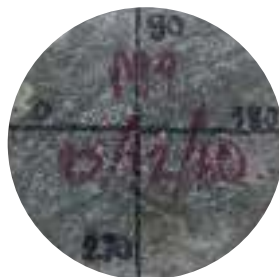
รูปที่ 3.10 การทำเครื่องหมายที่มุม 0, 90, 180 และ 270 องศา บนตัวอย่างทดสอบ
