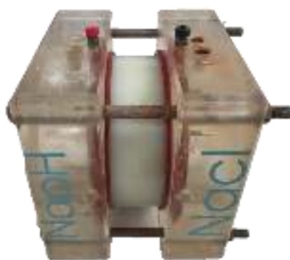
รูปที่ 3.19 การประกอบตัวอย่างเข้ากับเซลล์ทดสอบ
