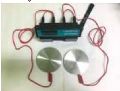
รูปที่ 3.13 การต่อสายไฟเข้ากับอุปกรณ์ทดสอบ
