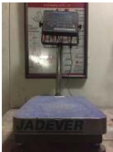
รูปที่ 3.9 เครื่องชั่งน้ำหนักแบบดิจิตอล ที่มีความละเอียดถึงทศนิยม 2 ตำแหน่ง
