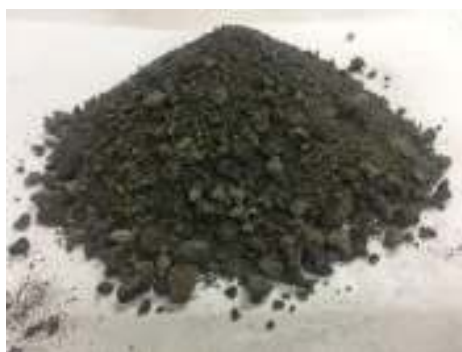
รูปที่ 3.5 เถ้าก้นเตา (Bottom ash) จากโรงไฟฟ้าแม่เมาะ จังหวัดลำปาง
