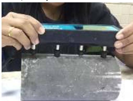
รูปที่ 3.12 การวัดความต้านทานไฟฟ้าที่ผิวของคอนกรีต
