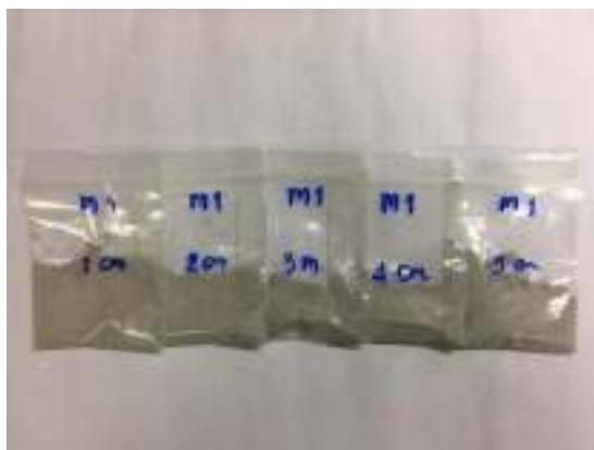
รูปที่ 3.27 ผงคอนกรีตที่บดละเอียด และแยกตามระดับความลึก
