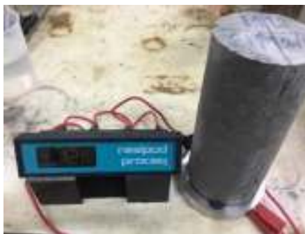
รูปที่ 3.15 การวัดค่าความต้านทานไฟฟ้าที่ฟองน้ำด้านล่าง
