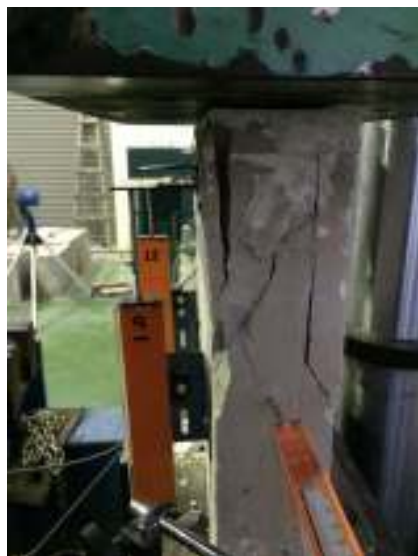
ตัวอย่างทดสอบ FS1-1 (วิธีแบบ Shear and split)
