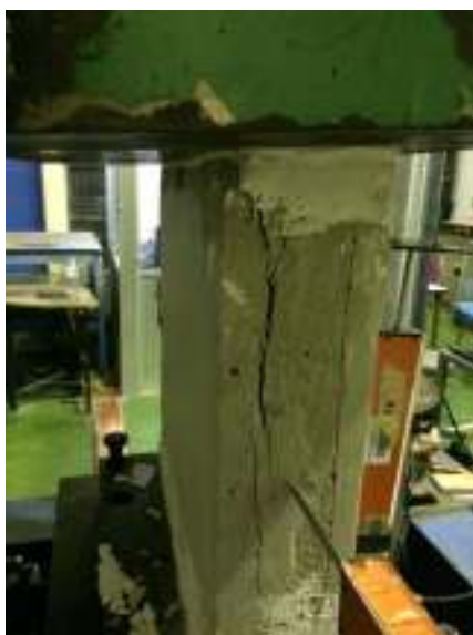
ตัวอย่างทดสอบ MT1-2 (วิธีแบบ Shear and split)
