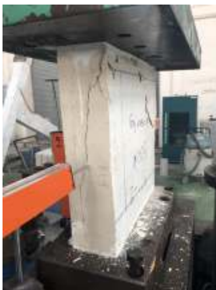
ตัวอย่างทดสอบ MT1-1 (วิธีแบบ Shear and split)
