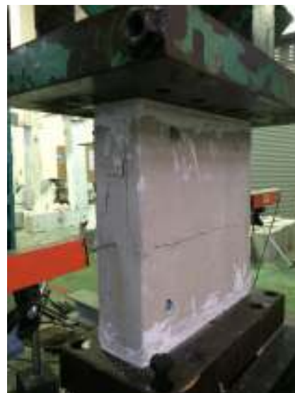
ตัวอย่างทดสอบ FS1-1 (วิธีแบบ Shear and split)
