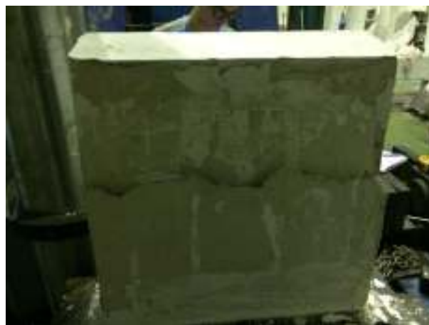
ตัวอย่างทดสอบ MS2-1 (วิธีแบบ Shear and split)
