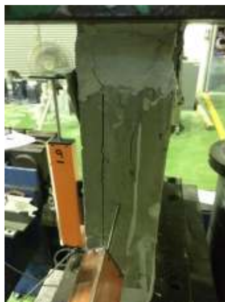
ตัวอย่างทดสอบ FT1-1 (วิธีแบบ Shear and split)
