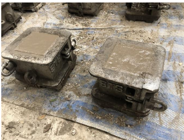
รูปที่ ค9 ตัวอย่างคอนกรีต
