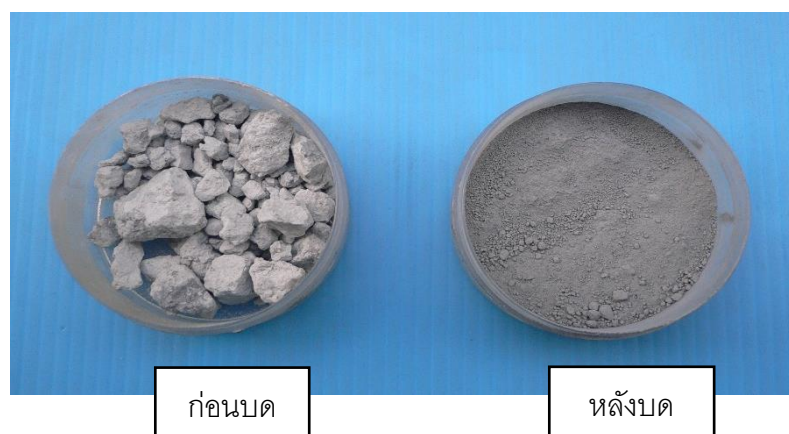
รูปที่ 2.2 ลักษณะทั่วไปและสีของกากแคลเซียมคาร์ไบด์
