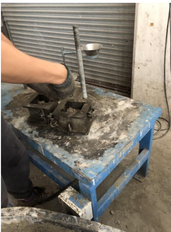
รูปที่ ค8 การเข้าแบบหล่อคอนกรีต
