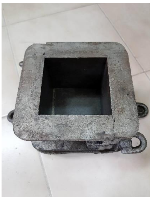
รูปที่ 3.11 แบบหล่อคอนกรีตทรงลูกบาศก์ขนาด 100x100x100 มม. 3
