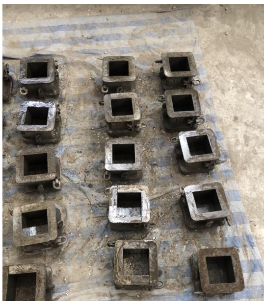
รูปที่ ค1 เตรียมแบบหล่อคอนกรีต
