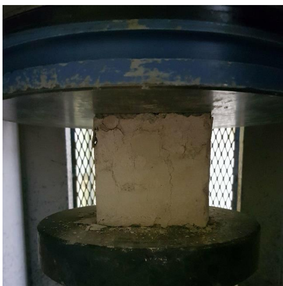
รูปที่ ค10 การทดสอบกำลังอัดและการแตกของคอนกรีต
