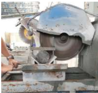
ภาพที่ 3-12 การตัดตัวอย่างออกเป็นชิ้นขนาดความหนา 5 เซนติเมตร เพื่อทำไปทดสอบ RCPT
