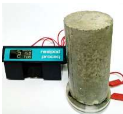
ภาพที่ 3-38 การวัดความต้านไฟฟ้าที่โฟมด้านล่างของคอนกรีต
