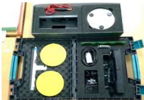
ภาพที่ 3-36 ชุดอุปกรณ์ทดสอบความต้านทานไฟฟ้าทั้งหมด
