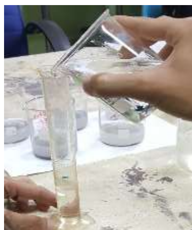
ภาพที่ 3-34 ใส่สารละลายไนตริกและสารละลายไฮโดรเจนเปอร์
