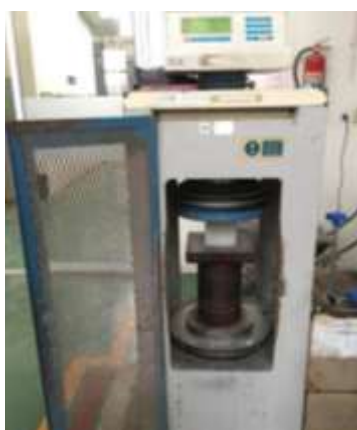
ภาพที่ 3-51 ทดสอบกำลังอัดของคอนกรีต
