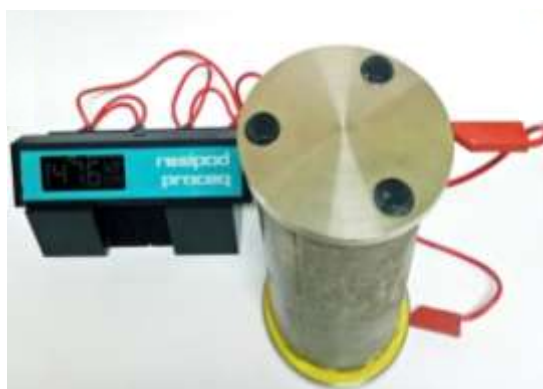
ภาพที่ 3-39 การวัดความต้านทานไฟฟ้าทั้งหมดของคอนกรีต
