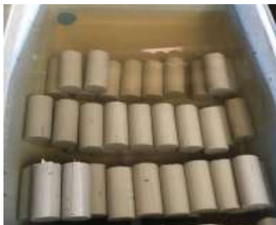
ภาพที่ 3-26 แซ่ตัวอย่างในสารละลายเกลือคลอไรด์ที่มีความเข้มข้น 3.0%
