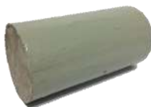
ภาพที่ 3-25 ทาอีพ็อกซีสีลงบนด้านล่างและด้านข้างของตัวอย่าง
