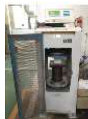
ภาพที่ 7 การทดสอบกำลังอัดของคอนกรีต
