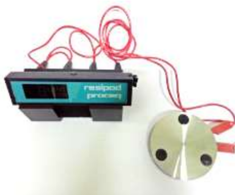
ภาพที่ 3-37 การวัดความต้านไฟฟ้าที่โพลีคาร์บอนของคอนกรีต
