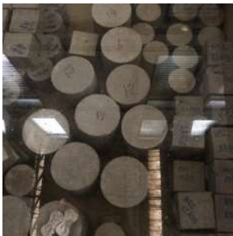
ภาพที่ 3-11 การบ่มตัวอย่างในบ่อบ่ม
