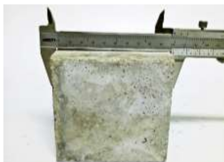
ภาพที่ 3-50 การวัดพื้นที่หน้าตัดของคอนกรีต
