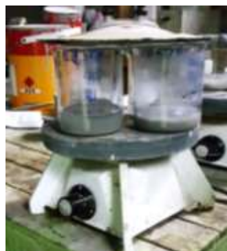
ภาพที่ 3-30 การให้ความร้อนแก่ตัวอย่างที่ใส่สารละลายไนตริกแล้ว
