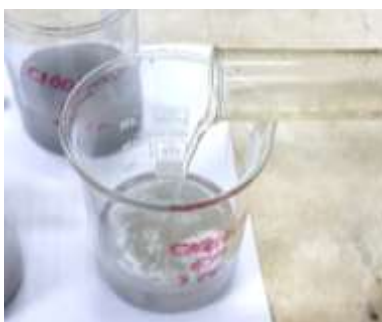
ภาพที่ 3-29 เติมนํ้ากลั่นและกรดไนตริก 25 ml. ลงในบีกเกอร์
