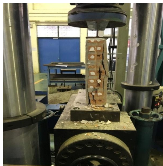
รูปที่ 4.4.1 รูปแบบการวิบัติของแรงอัด A
