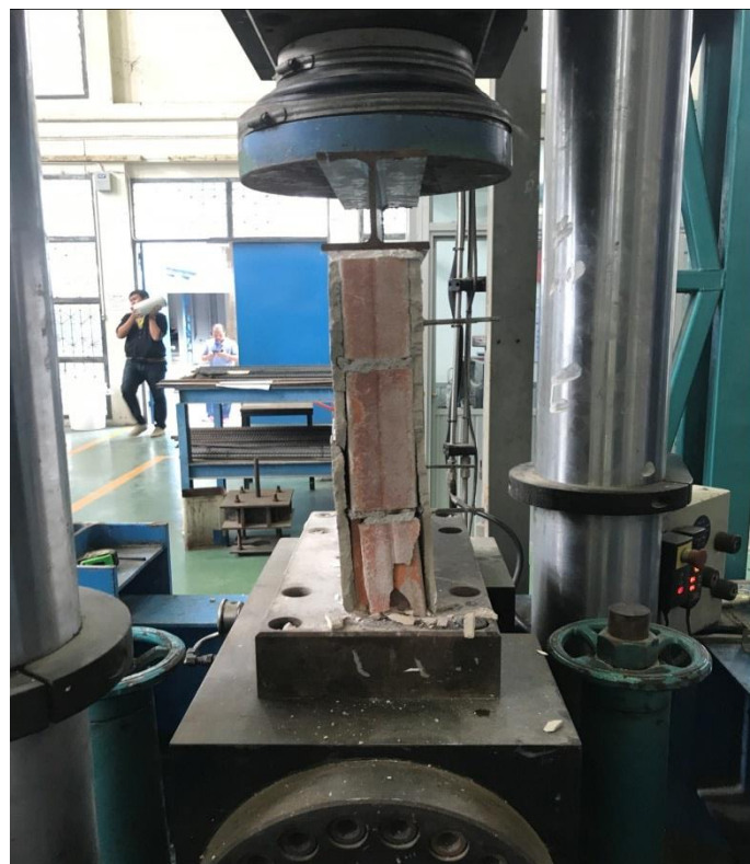
รูปที่ 4.4.2 รูปแบบการวิบัติของแรงอัด B
