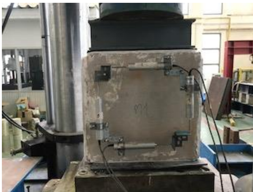
รูปที่ 3.4.1 การติดตั้งตัวอย่างทดสอบที่ไม่มีความเค้นในแนวราบ (ไม่มีแรง P_x ในแนวราบ)
