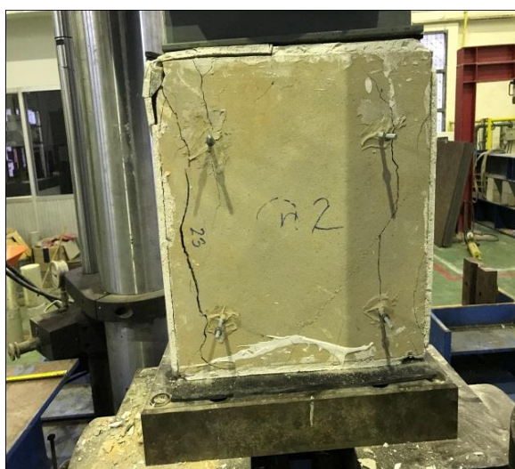
รูปที่ 4.4.1 รูปแบบการวิบัติของแรงอัด A
