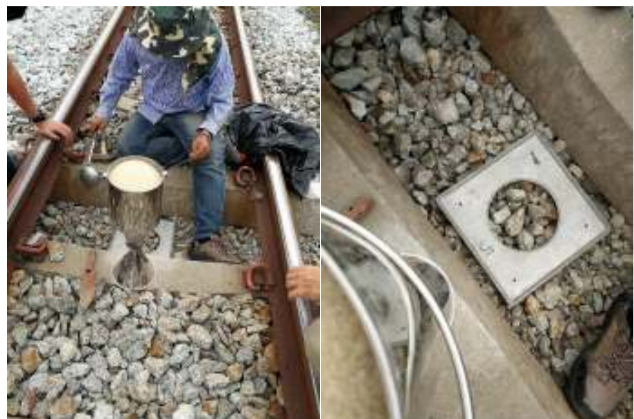
รูปที่ ข-2 ตำแหน่งการเก็บค่าการทดสอบ Sand cone method (ASTM1556)
