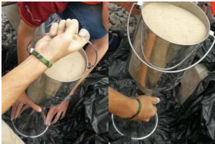
รูปที่ ข-4 การติดตั้งอุปกรณ์ Sand cone
