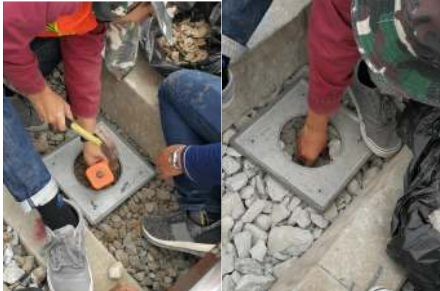
รูปที่ ข-3 การขุดหลุมสำหรับการเก็บค่าการทดสอบ Sand cone method
