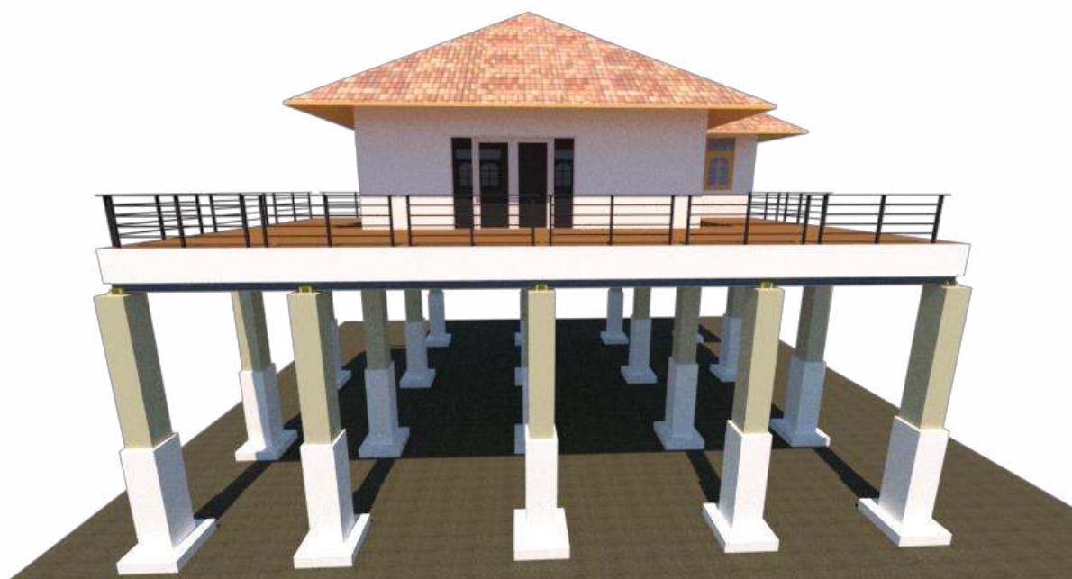
รูป 4.34 เรือนเล็กกลาง หลังจากเปลี่ยนเสา และ ยกอาคาร
