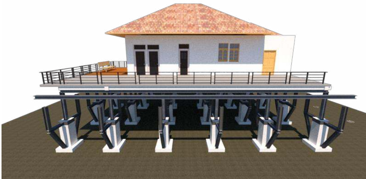
รูป 4.25 เรือนสายปรางโมทหลังจากเสริมเสาเหล็ก
