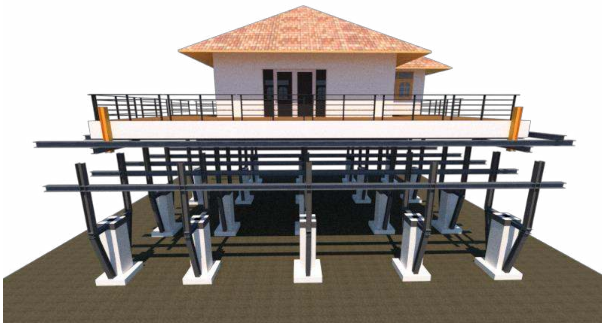
รูป 4.31 เรือนเล็กกลางหลังจากยกอาคาร
