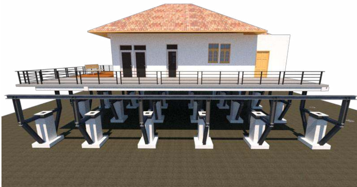
รูป 4.23 เรือนสายปราโมทหลังจากตัดเสา
