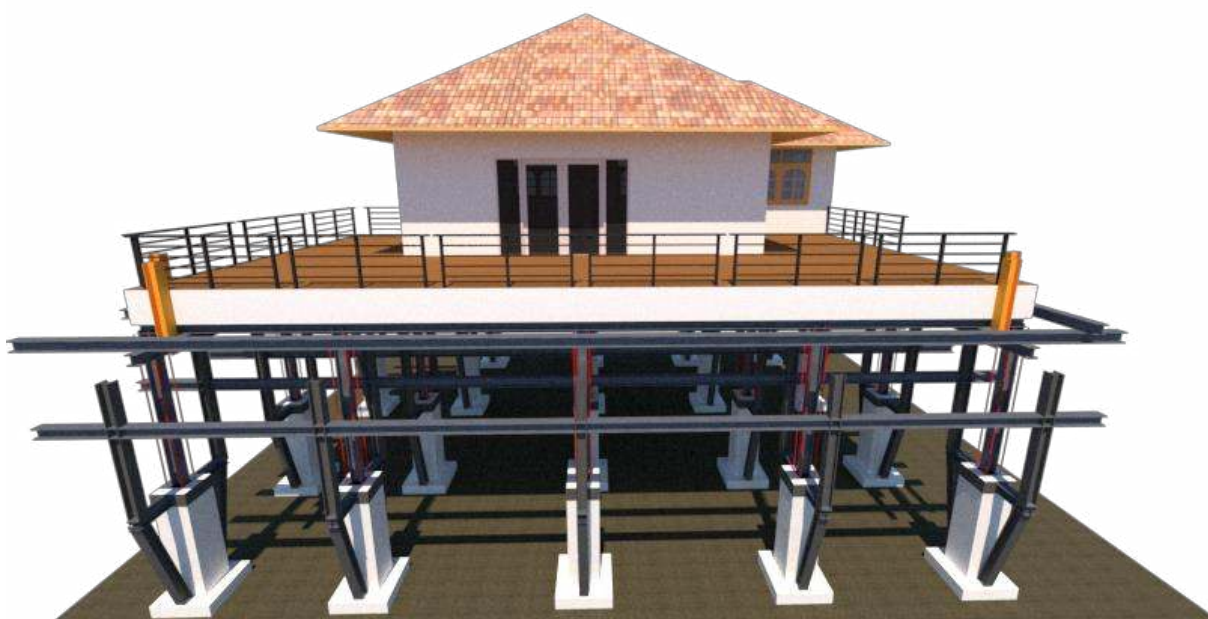
รูป 4.32 เรือนเล็กกลางหลังจากเสริมเสาเหล็ก
