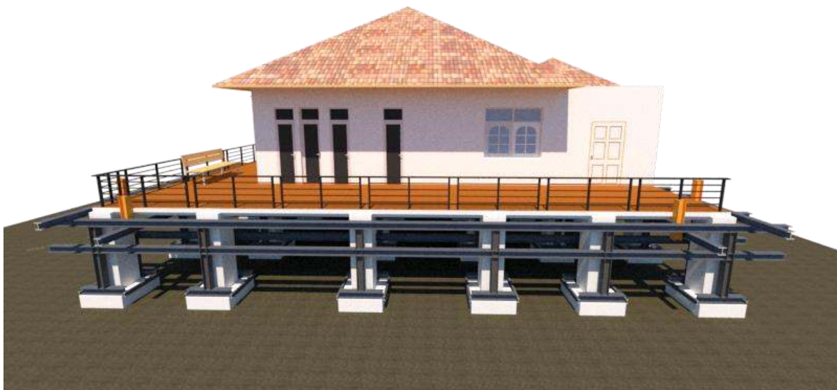
รูป 4.15 รูปแบบจำลองเรือนเจริญโชติสวัสดิ์หลังติดตั้งโครงสร้างรับแรงจากอาคารด้านบน
