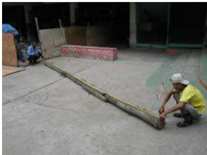
รูปที่ 2.27 เสาเข็มไม้ขนาดเส้นผ่านศูนย์กลาง 15 เซนติเมตรและยาว 6 เมตร
