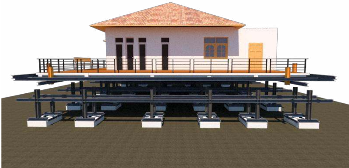
รูป 4.17 เรือนเจริญโชติสวัสดิ์หลังจากยกอาคาร
