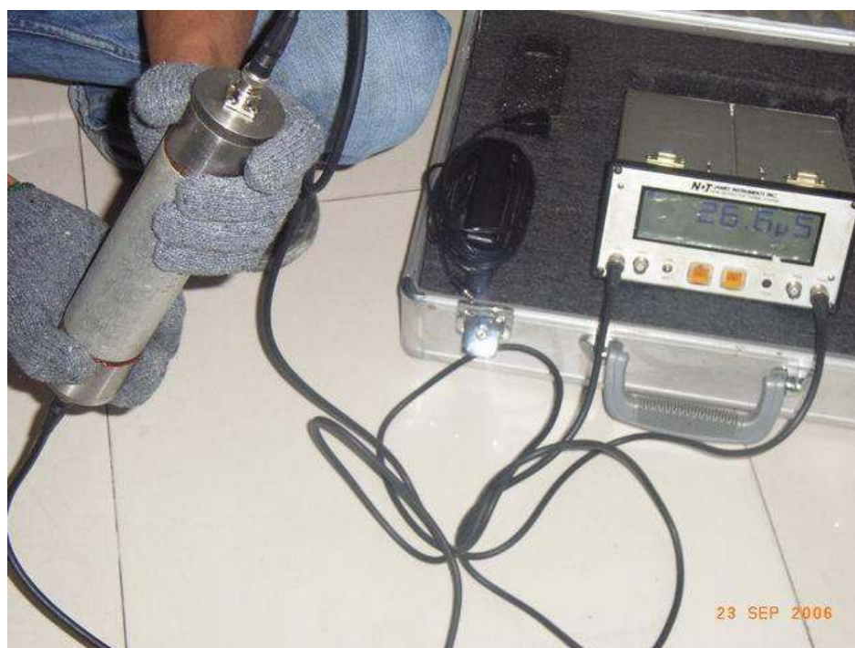
รูปที่ 2.29 การทดสอบกำลังของคอนกรีตแบบไม่ทำลาย (UPV)
