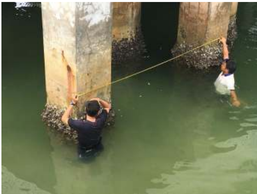
ภาพที่ 3 การลงพื้นที่วัดตำแหน่งของโครงสร้าง
