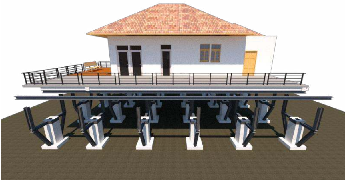
รูป 4.24 เรือนสายปราโมทหลังจากยกอาคาร
