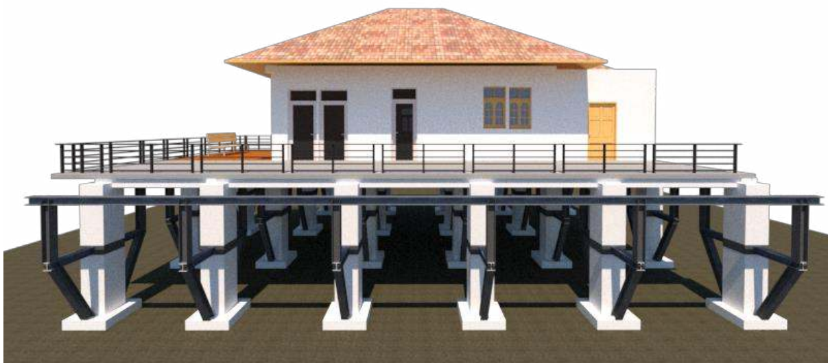
รูป 4.22 รูปแบบจำลองเรือนสายปรางโมทหลังติดตั้งโครงสร้างรับแรงจากอาคารด้านบน
