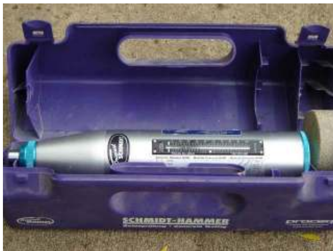
รูปที่ 3.5เครื่องมือ Schmidt Hammer ที่ใช้ในการทดสอบ
