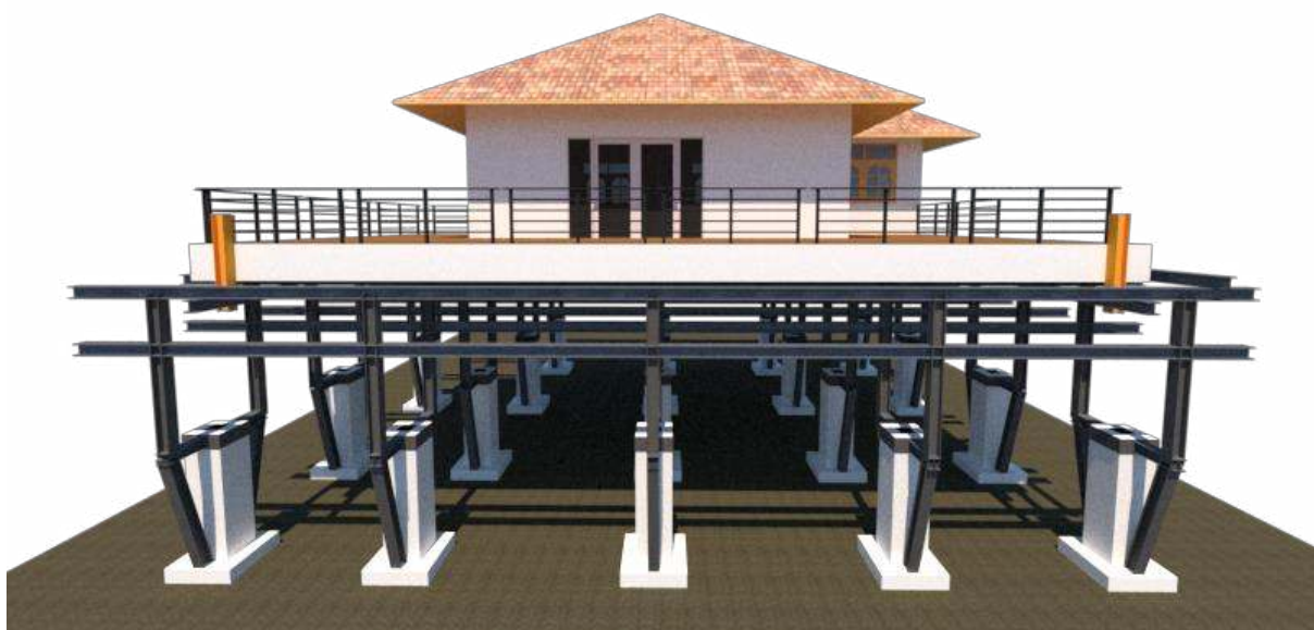
รูป 4.37 เรือนเล็กริมหลังจากตัดเสา
