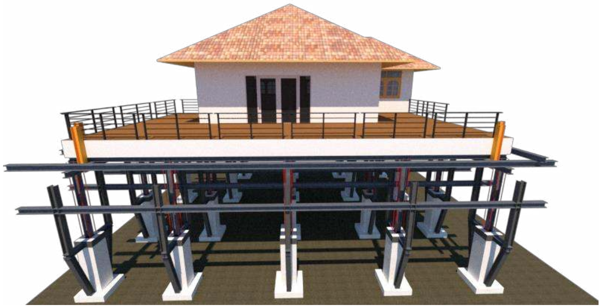
รูป 4.39 เรือนเล็กริมหลังจากเสริมเสาเหล็ก
