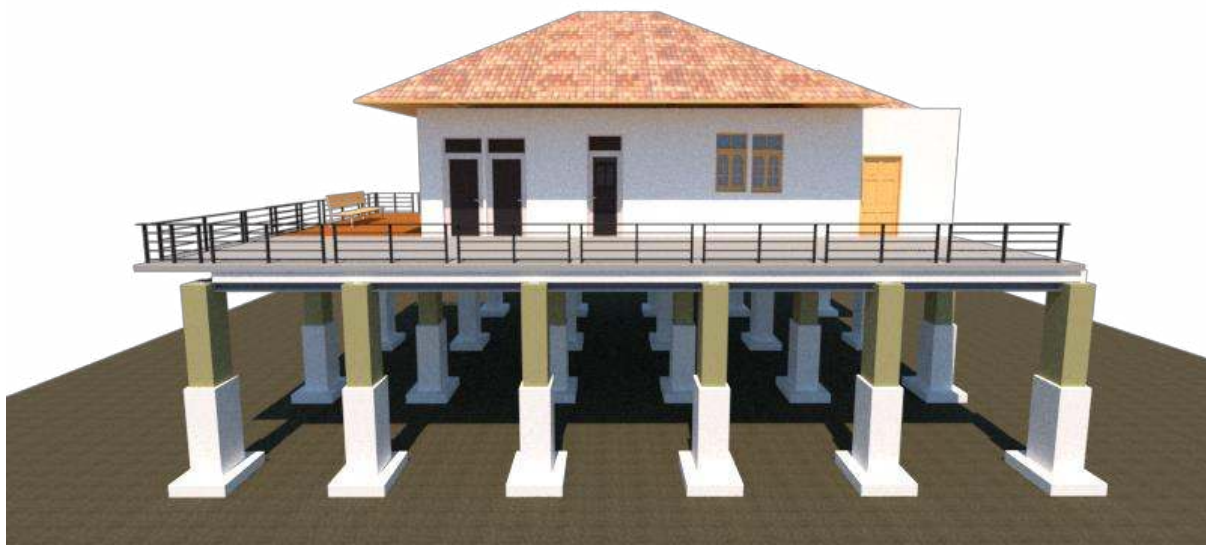
รูป4.27เรือนสายปรางโมท หลังจากเปลี่ยนเสา และ ยกอาคาร
