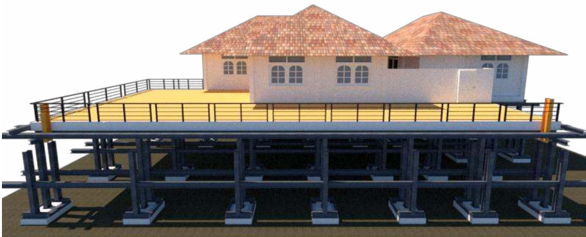
รูป 4.12 แบบจำลองเรือนรัฐธรรมนูญหลังจากยกอาคารและติดตั้งเสาเหล็กรับแรง
