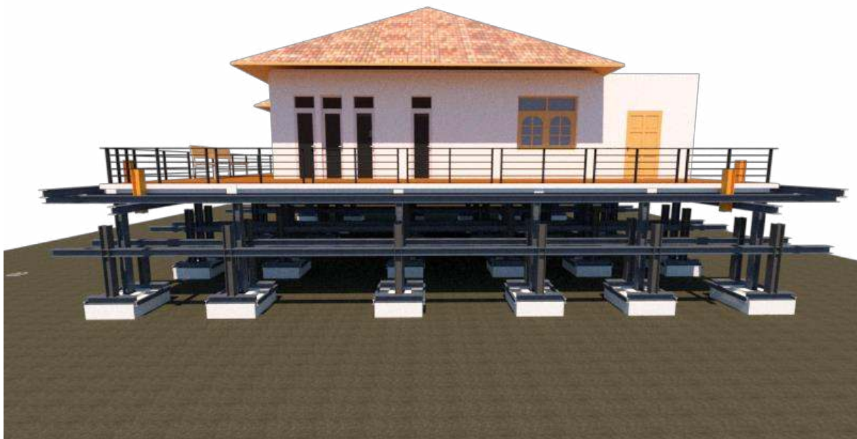
รูป4.18 เรือนเจริญโชติสวัสดิ์หลังจากเสริมเสาเหล็ก
