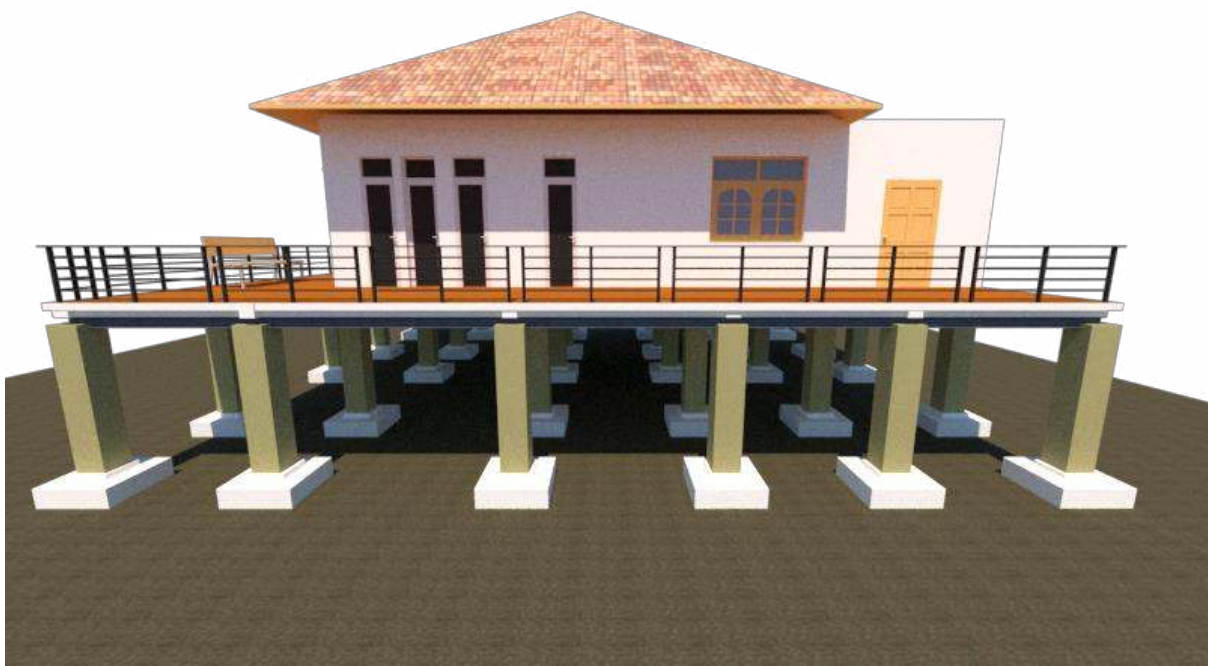
รูป 4.20 เรือนเจริญโชติสวัสดิ์ หลังจากเปลี่ยนเสา และ ยกอาคาร
