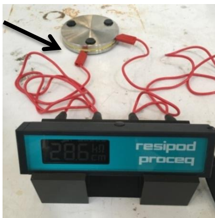
ภาพที่ 3.10 วัดค่าความต้านทานของแผ่นโคมด้านบน
