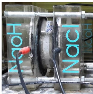
ภาพที่ 3.5 ลักษณะการประกอบตัวอย่างเข้าเซลล์
