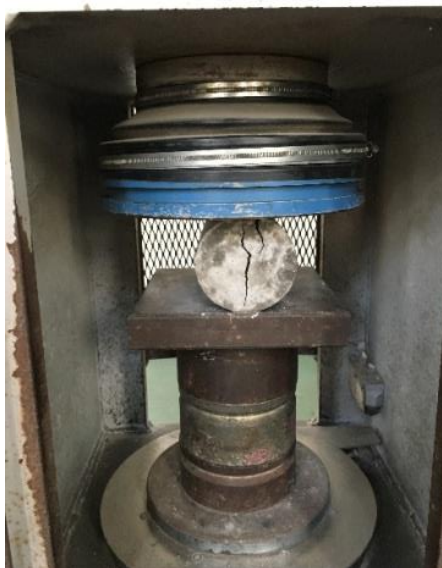
รูปที่ 3.15 การทดสอบกำลังดึงของคอนกรีตด้วยวิธีการผ่าซีก
