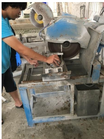
ภาพที่ 3.4 การตัดตัวอย่างคอนกรีตรูปทรงกระบอก
