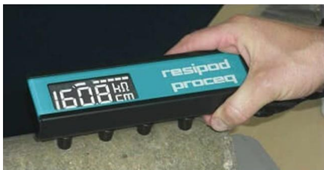
ภาพที่ 3.8 การทดสอบความต้านทานไฟฟ้าที่ผิว
