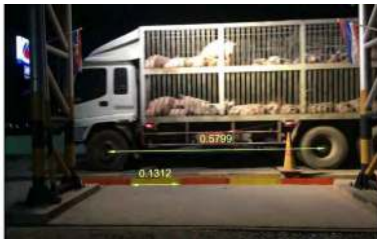
ภาพที่ 3-21 ตัวอย่างภาพหนึ่งที่ได้จากการบันทึกที่ด้านตรวจสอบน้ำหนัก เพื่อหาระยะห่างระหว่างเพลานในโปรแกรม AutoCAD
