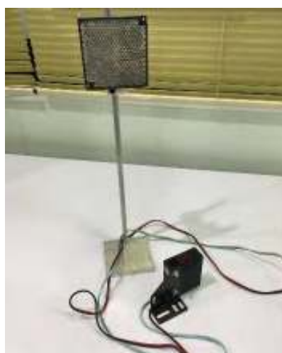
ภาพที่ 3-9 เซนเซอร์ตรวจจับวัตถุโดยใช้แสง (photoelectric sensor และ reflector)
