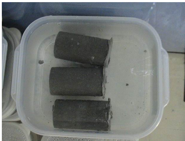
ภาพที่ 3.7 ชิ้นตัวอย่างที่เคลือบผิวด้านข้างด้วยสารกันซึม
