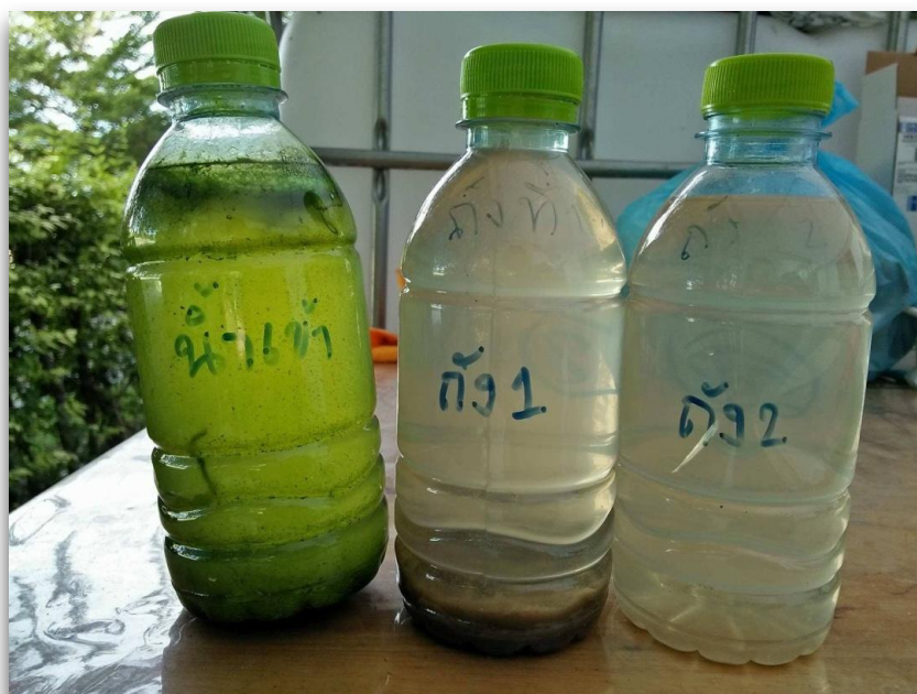
รูปที่ 5.8 ตัวอย่างน้ำเข้า น้ำออกจากถังที่ 1 น้ำออกจากถังที่ 2 และตะกอนของน้ำถังที่ 1 และ 2 หลังจากวางไว้สองอาทิตย์ พบว่าน้ำเสียที่ยังไม่ผ่านการบำบัดเปลี่ยนเป็นสีเขียวเนื่องจากการเติบโตของพืชน้ำ
