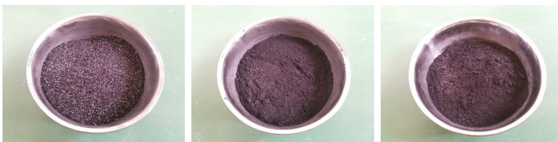
a.) เถ้ากลบไม่บด ค้ำบนตะแกรงเบอร์ 325 ร้อยละ 48 (OR) b.) เถ้ากลบบดค้ำบนตะแกรงเบอร์ 325 ร้อยละ 34 (MR) c.) เถ้ากลบบดค้ำบนตะแกรงเบอร์ 325 ร้อยละ 29 (FR)
