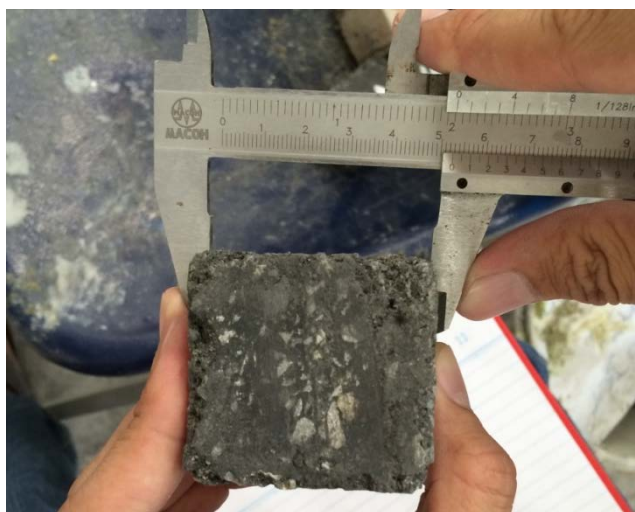
รูปที่ 3.20 การวัดขนาดตัวอย่างคอนกรีตบล็อก
