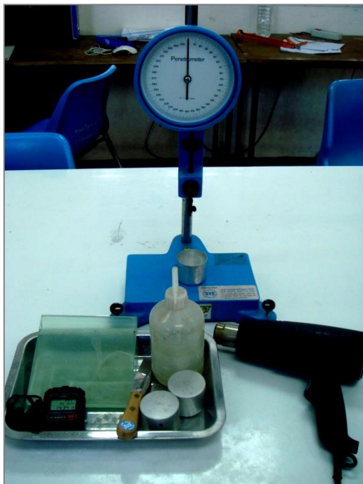
รูปที่ 3.7 ชุดอุปกรณ์หาค่าพิกัดเหลวและพิกัดพลาสติก โดยวิธีตกตึง ตามมาตรฐาน BS 1377-2
