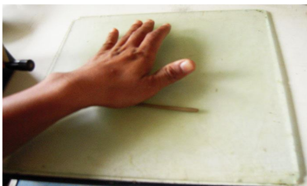
รูปที่ 3.11 ปั้นคลึงดินให้มีขนาดเส้นผ่านศูนย์กลาง 3.2 มิลลิเมตร
