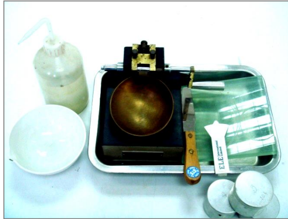
รูปที่ 3.5 ชุดอุปกรณ์หาค่าพิกัดเหลวและพิกัดพลาสติก ตามมาตรฐาน ASTM D 4318
