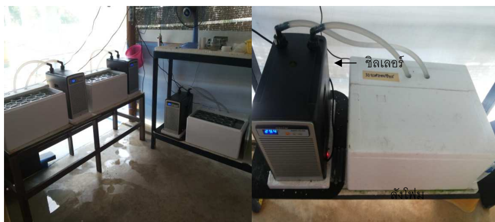
ภาพที่ 3 การควบคุมอุณหภูมิของภาชนะทดลองที่แตกต่างกัน 3 ระดับ คือ 25.0, 27.0, 30.0 (ควบคุม) °C ด้วยการใช้อุปกรณ์ทำความเย็น(chiller) รุ่น Hailea Hs-28A และปั๊มสำหรับป้องกันการเปลี่ยนแปลงของอุณหภูมิจากภายนอก
