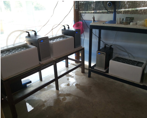
ภาพผนวกที่ 3 แสดงรูปการทดลอง โดยใช้ ซิตเลอร์ในการควบคุมอุณหภูมิ
