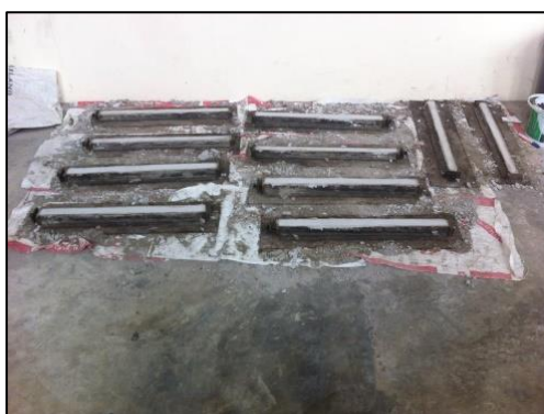
ภาพที่ 3-10 ตัวอย่างแบบหล่อและ ก้อนลูกบาศก์คอนกรีตที่ใช้ในการทดลอง
