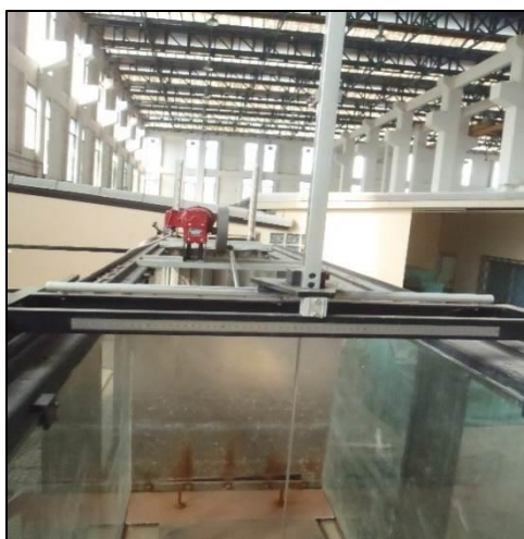
ภาพที่ 3-7 เครื่องวัดระดับน้ำแบบเข็มชี้ (Point Gauge)
