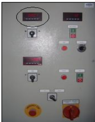
ภาพที่ 3-18 แผงควบคุมเครื่องทดสอบทางน้ำไหล
