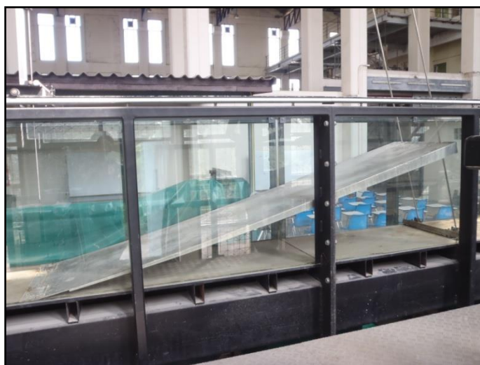
ภาพที่ 3-13 โครงสร้างพื้นเอียงที่ใช้รองรับพื้นผิวลูกบาศก์คอนกรีต
