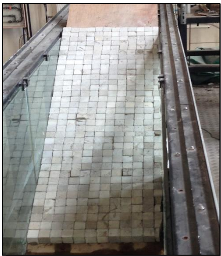
ภาพที่ 3-14 พื้นลูกบาศก์คอนกรีตจัดเรียงแบบเรียบ
