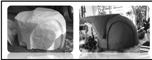
ภาพที่ 16 - 17 ภาพต้นแบบด้วยการตัดโฟมและพอกด้วยดินเหนียว
