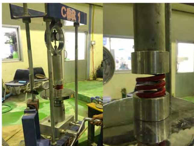
รูปที่ 4.27 การสอบเทียบ Proving ring ด้วยสปริงมาตรฐาน
