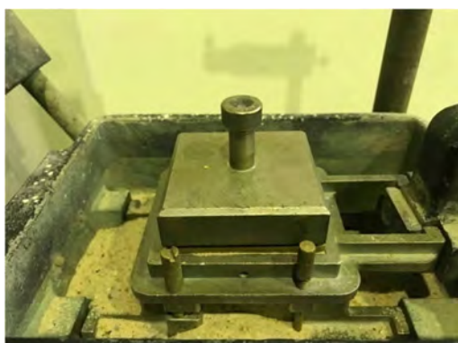
รูปที่ 4.11 วางแผ่นเหล็กเตรียมถ่ายโหลด
