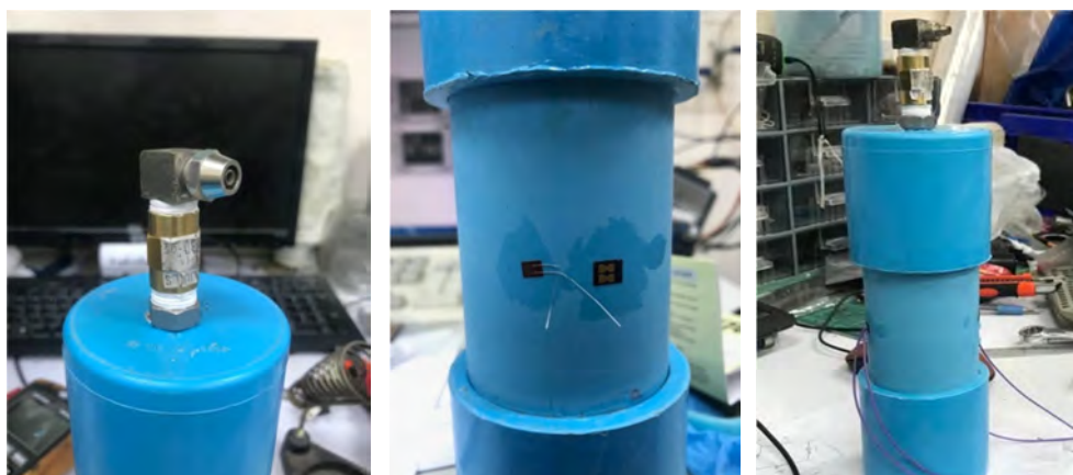
รูปที่ 4.23 เจาะรูเพื่อใส่ท่อแรงดันลม และติดชุดสเตรนเกจ
