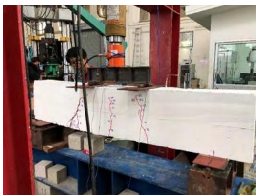
รูปที่ 4.7 การวิบัติของคาน B6
