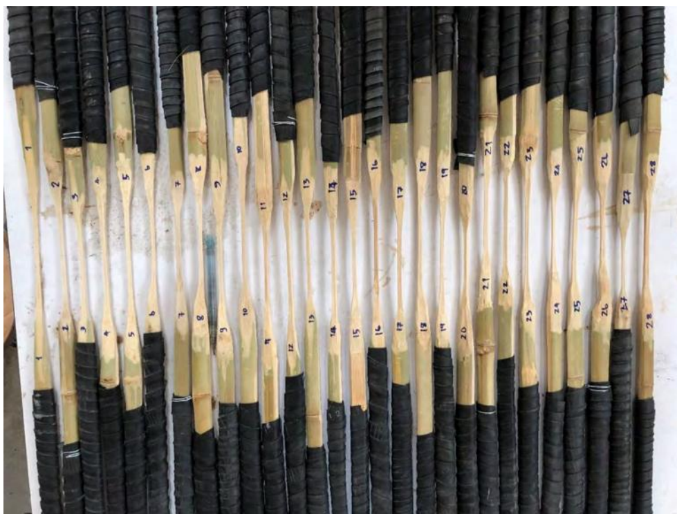
รูปที่ 3.13 ตัวอย่างทดสอบการรับแรงดึงของไม้ไผ่
