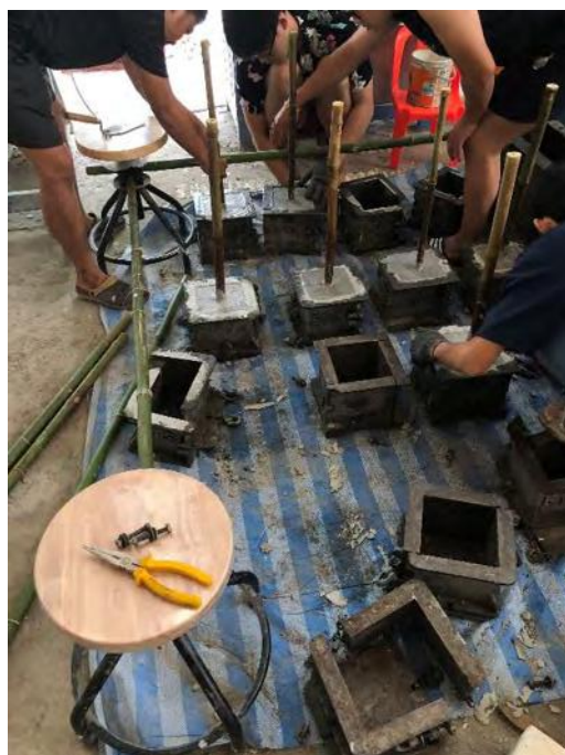
รูปที่ ข-2 รูปผูกไม้ในการหล่อตัวอย่างทดสอบแรงยึดเหนี่ยวเพื่อให้ไม้ไฟตั้งตรง
