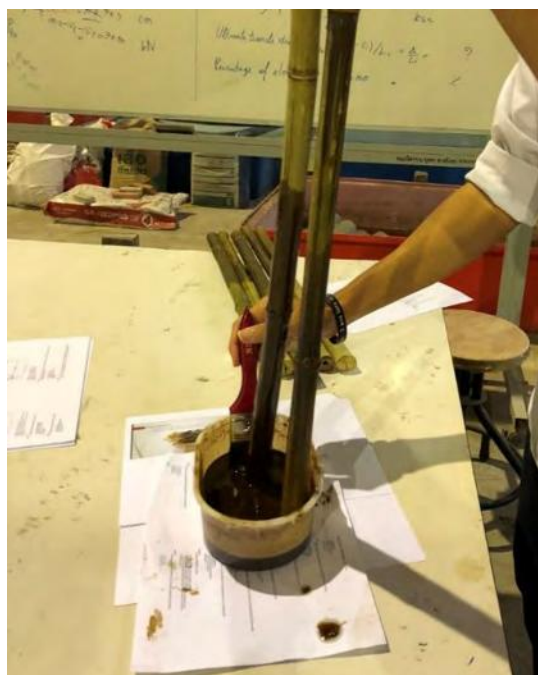
รูปที่ 3.15 การเคลือบผิวไม้ไผ่ด้วยชัน
