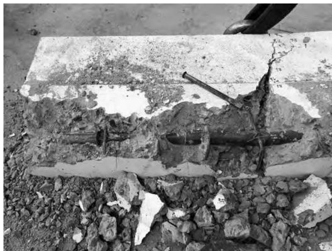
รูปที่ 4.9 การสกัดผิวเนื้อคอนเพื่อตรวจสอบการยึดเหนี่ยวไม้ไผ่กับคอนกรีต
