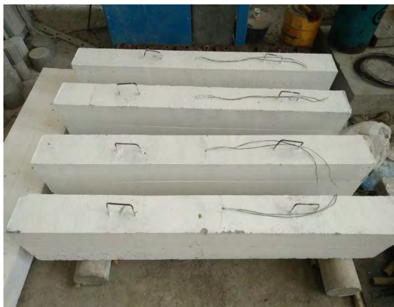
รูปที่ 3.20 ตัวอย่างคานคอนกรีตเสริมไม้ไผ่เคลือบผิวด้วยชัน
