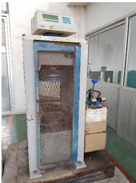
รูปที่ 3.8 เครื่องทดสอบแรงอัด (Compression testing machine) ขนาด 300 ตัน
