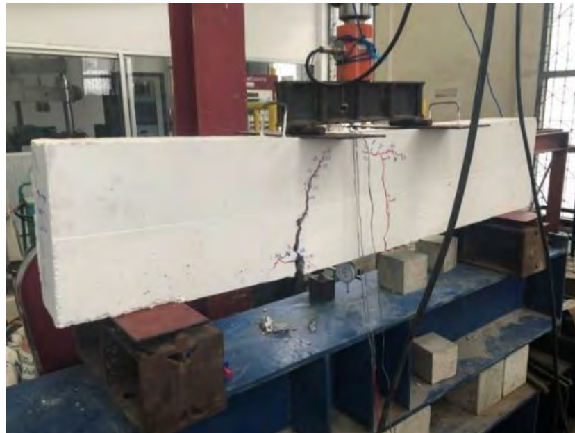
รูปที่ 3.27 การทดสอบกำลังดัดของคานคอนกรีตเสริมไม้ไผ่ที่เคลือบผิวด้วยชัน
