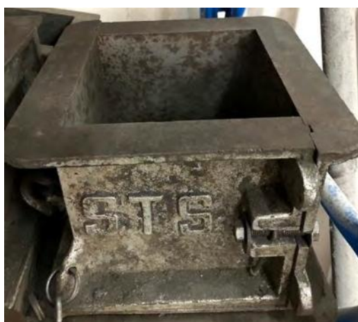
รูปที่ 3.3 แบบหล่อขึ้นตัวอย่างทรงลูกบาศก์ ขนาด 15 \times 15 \times 15 ซม. 3
