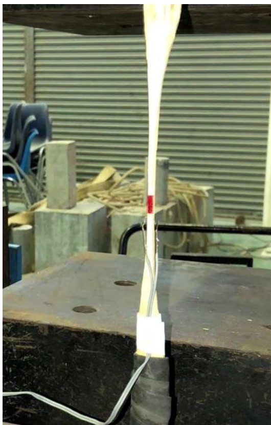
รูปที่ 3.14 ติดตั้งอุปกรณ์วัดระยะยืด-หด (Electrical strain gauge)
