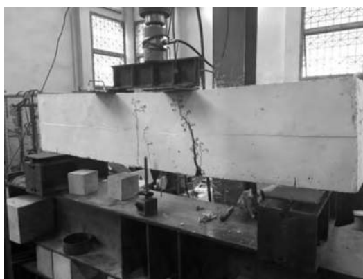
รูปที่ 4.5 การวิบัติของคาน B3
