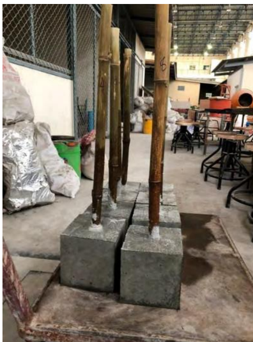
รูปที่ 3.16 ตัวอย่างทดสอบทดสอบแรงอัดเหนียวของคอนกรีตต่อไม้ไผ่
