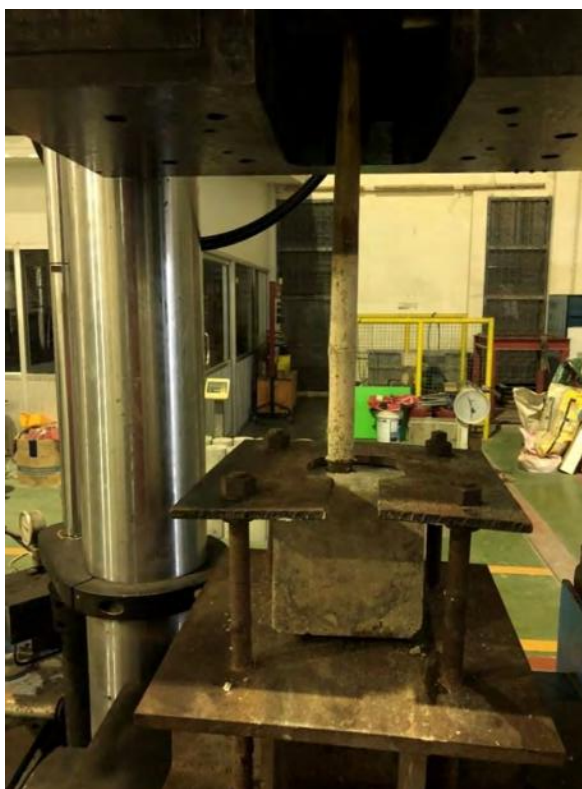
รูปที่ 3.22 การทดสอบกำลังยึดเหนี่ยวของคอนกรีตต่อไม้ไผ่
