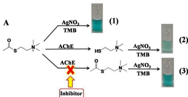
ภาพที่ 13 : การจางลงของสีที่เกิดจากปฏิกิริยาออกซิไดซ์ระหว่าง Ag + ion กับ tricholine (74)
