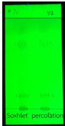
ภาพที่ 35 : สารสกัดว่านเหลืองที่สกัดด้วยวิธี Soxhlet และ percolation ที่ทำการแยกด้วยวัฏภาค toluene : chloroform : absolute ethanol (49:49:2) และทำการส่องภายใต้แสง UV ที่ความยาวคลื่น 254 nm
